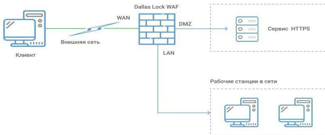
Рисунок 1. Типовая схема использования «WAF Dallas Lock»
